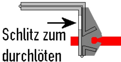
Den Adapter entsprechend den Bildern falten und zur Versteifung verlöten. Eventuell die seitlichen Schlitz für die Haltenasen der Kupplung und den Durchsteckschlitz mit einer feinen Schlüsselfeile etwas aufweiten.
