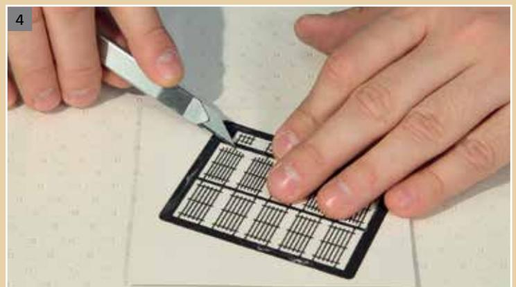
Dann die benötigten Teile mit einem Cuttermesser vorsichtig aus der Platine schneiden.
