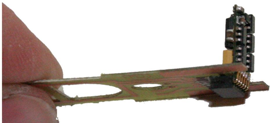
Jetzt können sie den alles wieder zusammenbauen. Als erstes wird die Platine mit dem Motor eingesetzt.
